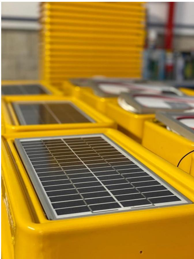
La soluzione si fonda **sull'installazione di un modulo hardware ad alimentazione solare, incorporato nel contenitore ed in costante comunicazione con la centrale operativa che coordina i mezzi dedicati al servizio di raccolta.**
